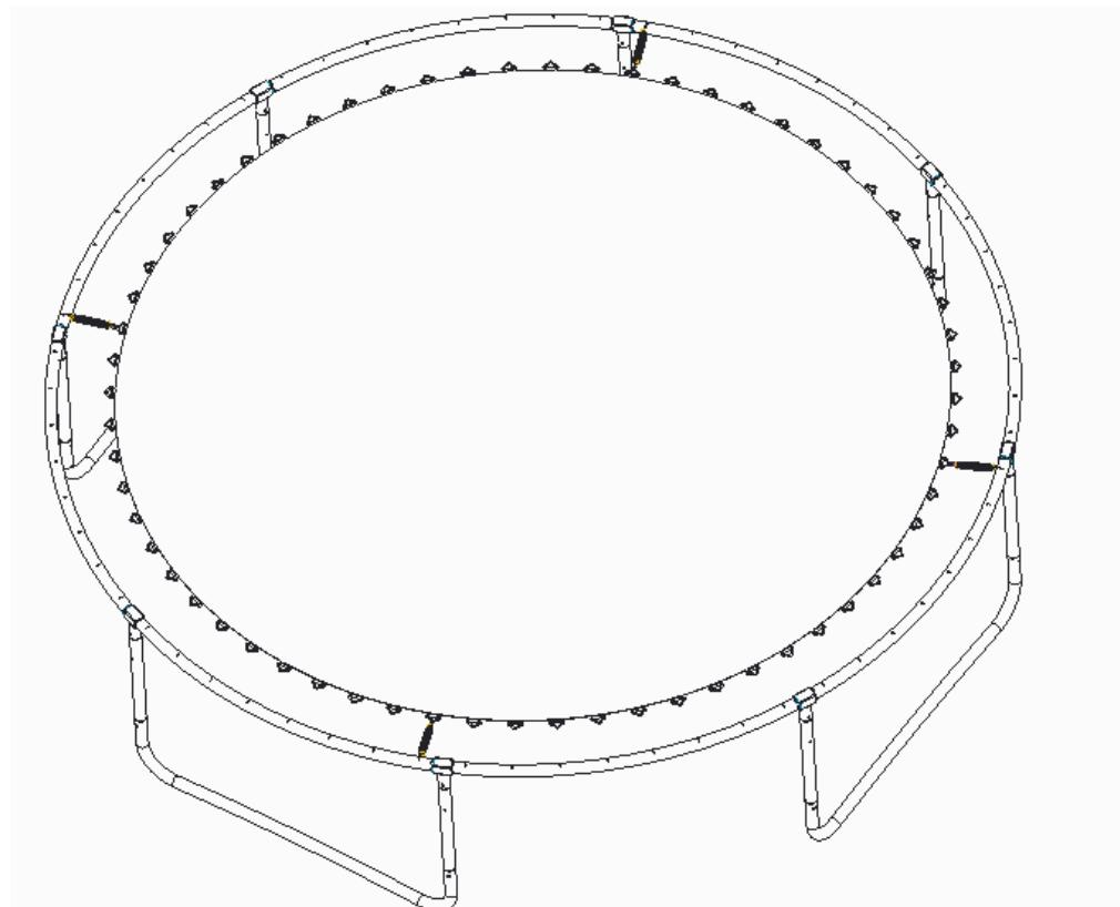
6. Postavite i zategnite preostale opruge. Ne pomerajte trambolinu dok se sklapanje ne završi.
