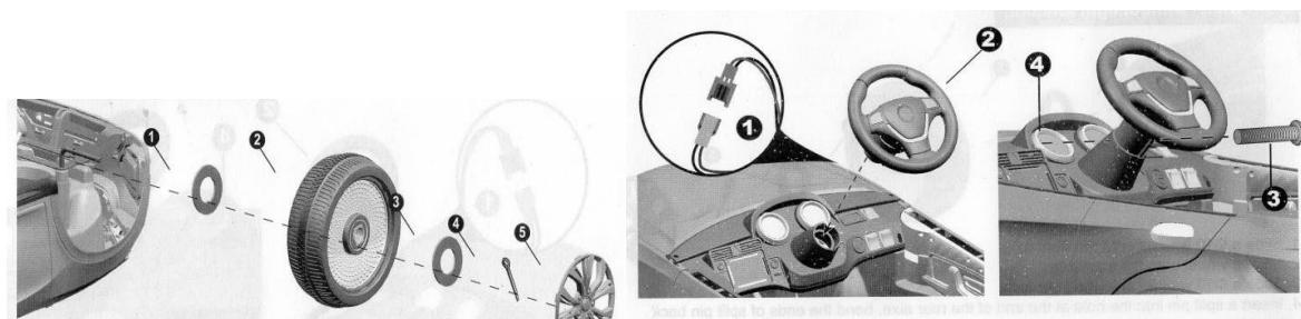
Montiranje I povezivanje volana, slika iznad.
